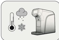
Installieren Sie das Gerät nicht an einem Ort, an dem die Temperatur unter Null fällt.
