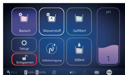
1. Halten Sie die Sperrtaste für 3 Sek. gedrückt um die Sperre zu aktivieren. Alle Funktionen außer der Start- / Stoptaste werden gesperrt/deaktiviert.
