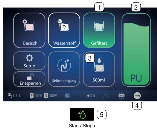
1. Wählen Sie die Schaltfläche „Gefiltert“ um gefiltertes Wasser zu erzeugen.
