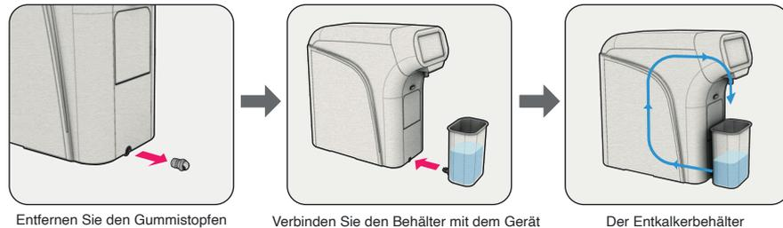
4. Sobald die Vorbereitung für die Entkalkung abgeschlossen ist, drücken Sie die Taste **D 0%**. Starten Sie den Entkalkungsvorgang in dem Sie mit „JA“ bestätigen. Der Entkalkungsvorgang wird nach Ablauf der 30min. automatisch beendet und die Anzeige setzt sich auf 100%. Bei hohem Verkalkungsgrad bitte den Vorgang wiederholen.
